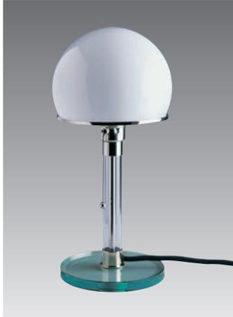
Diese Variante der im selben Jahr entstandenen Metall-Tischlampe hat einen Glasfuß und einen Glasstab, in dem ein vernickeltes 10-mm-Rohr die Zuleitung führt. Zur Konstruktion lagen eine alte Zeichnung und eine Original-Leuchte vor, so dass genau die Maße und Proportionen bei der Neufertigung eingehalten werden konnten. Alle Leuchten tragen auf der Kontermutter unter der Fußplatte das Bauhaus- und das Technolumen-Zeichen.
